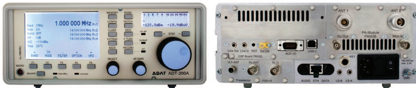
Obr. 1. a 2. Pohled na přední a zadní panel transceiveru ADT-200A
